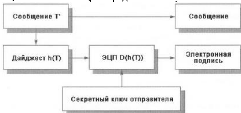
Рисунок 2 – Схема установки ЭЦП
