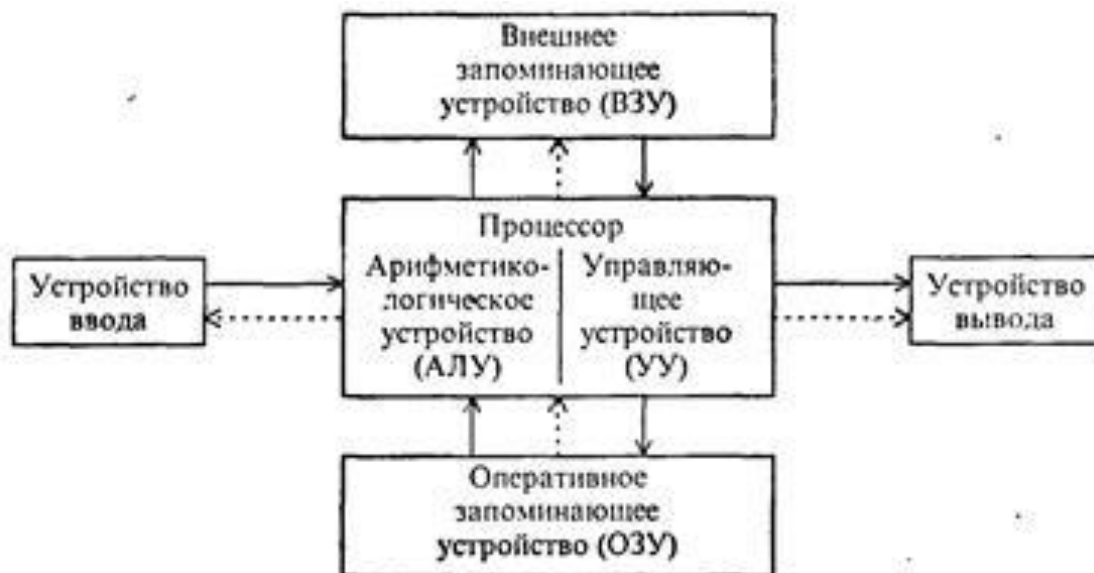
Рисунок 1 - Условная модель структуры архитектуры ЭВМ
