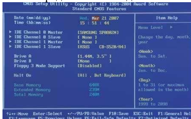
Рис. 2.3. Меню Standard CMOS Features утилиты CMOS Setup
