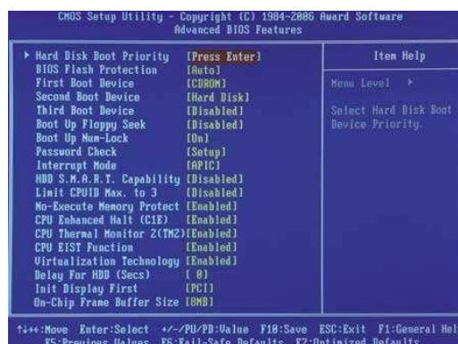
Рис. 2.4. Меню Advanced BIOS Features утилиты CMOS Setup
