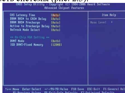
Рис. 2.5. Меню Advanced Chipset Features утилиты CMOS Setup
