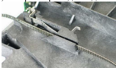
Рис. 6.13. Место крепления ремня к сканирующей каретке
