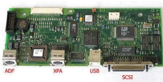
Рис. 6.12. SCSI- и USB-порты в интерфейсной плате
